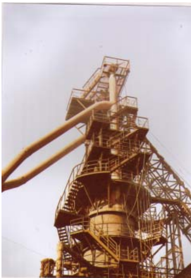
写真5 山西省の小型高炉 (内容積125M 3 :我が国の40分の1) なかなかのもの
