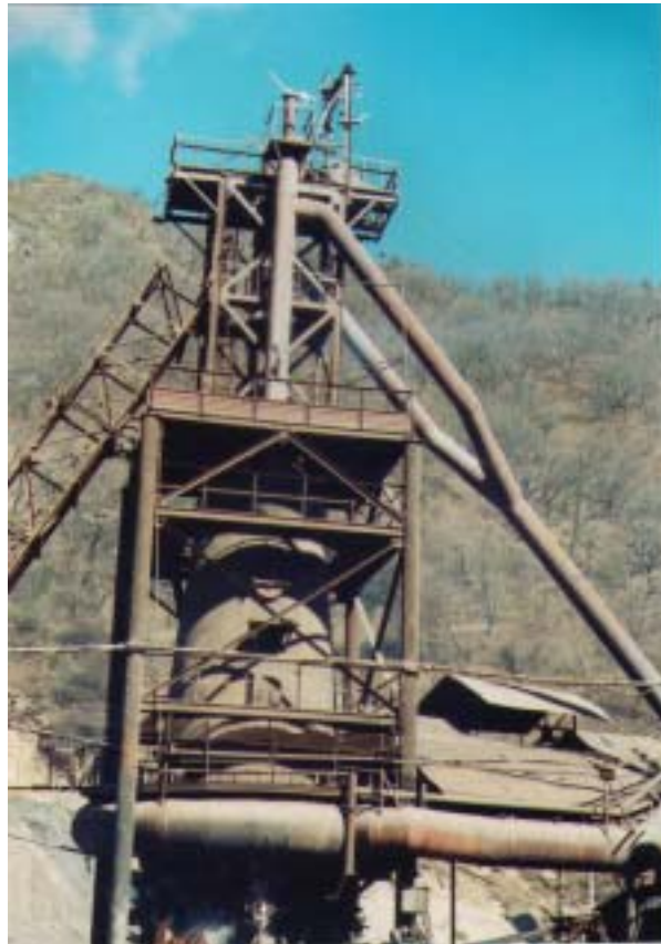
写真4 山西省の小型高炉(2) (内容積50M 3 :我が国の100分の1) いくらもしっかりしている
