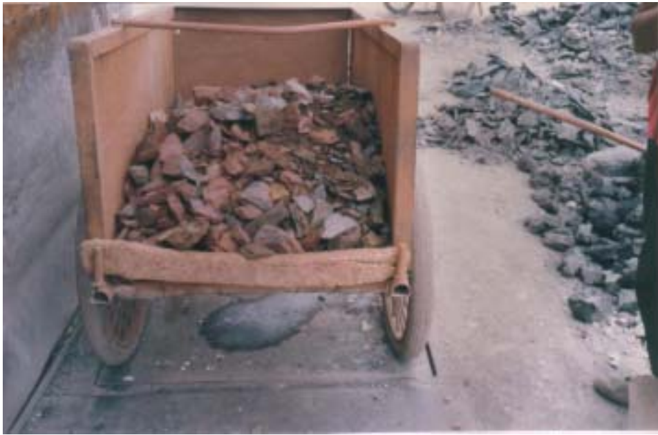
写真 11 大きな装入物（鉱石） （これでは高炉は下痢をする：黒い鉱滓の原因の一つ）
