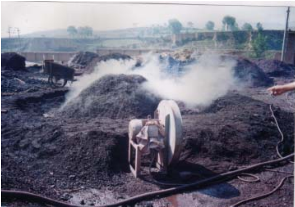
写真 18 野焼き焼結法 ( 焼結：粉鉱石を粉コークスで焼いて塊にする )
